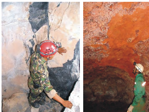
Figura 5.8 e 5.9: Na esquerda, caverna em frente de lavra ao norte do Distrito Federal, em Goiás. Na direita, caverna em minério de ferro próxima à frente de lavra na região de Carajás-PA. Em ambas, notar a diferença de cor entre a rocha sã e as rachaduras nas paredes da caverna.
