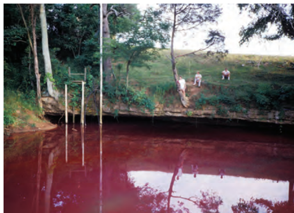
Figura 2.18. Utilização de traçador corante (rodamina) em ressurgência nos Estados Unidos.
